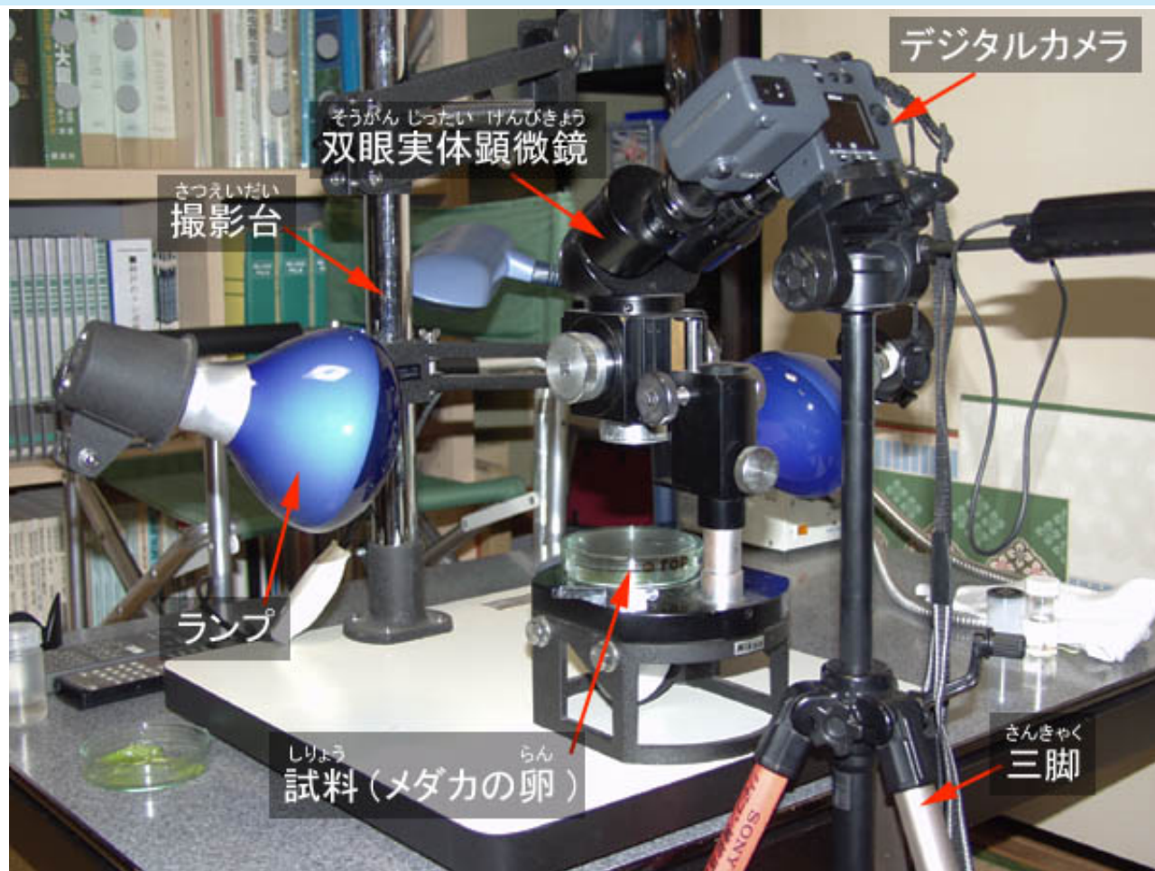
自宅にセットしたメダカの発生の撮影装置
