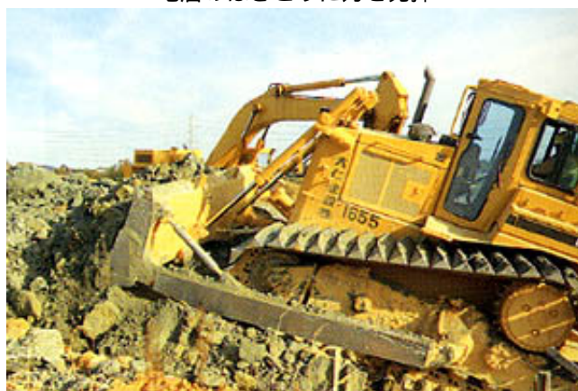
パワーショベルとブルドーザーのコンビは、 地層のはぎとりに力を発揮
