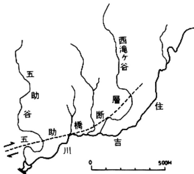
右ずれの五助橋断層
