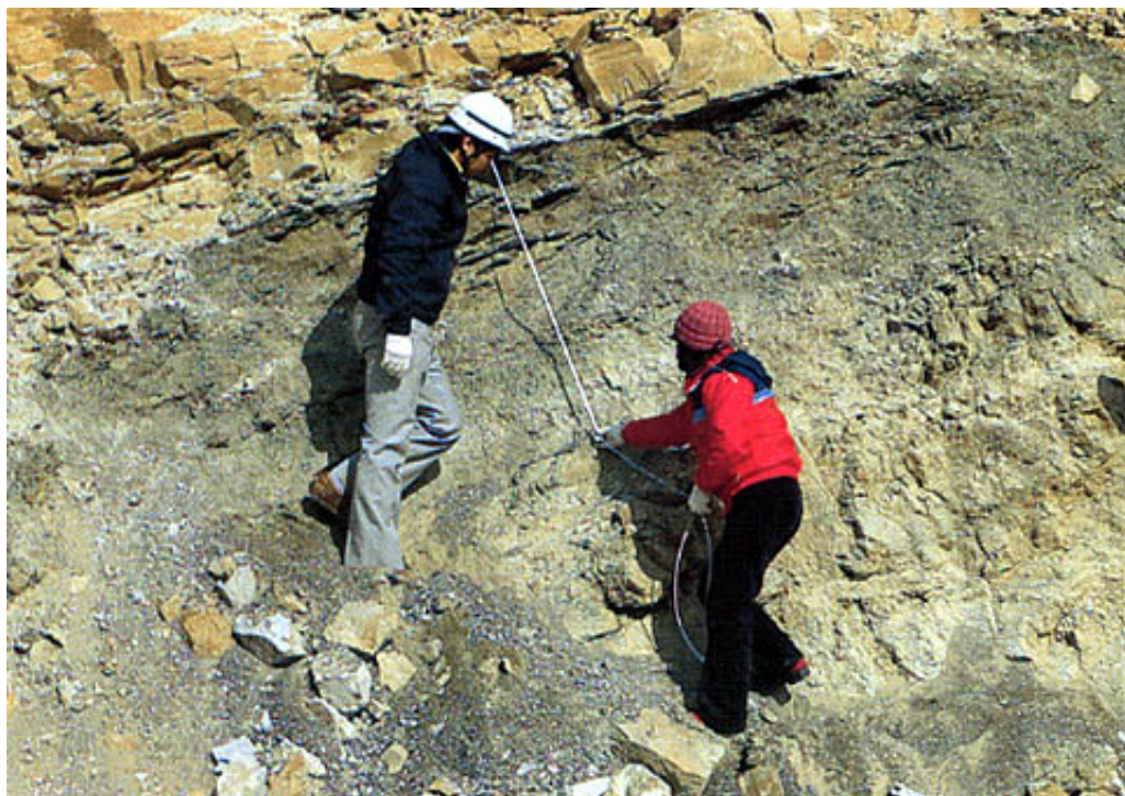
地層の厚さを調べる 地層の面に垂直に巻尺をあてる
